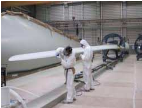
"Trabajadores llevando a cabo las labores de reparación de unas palas"
